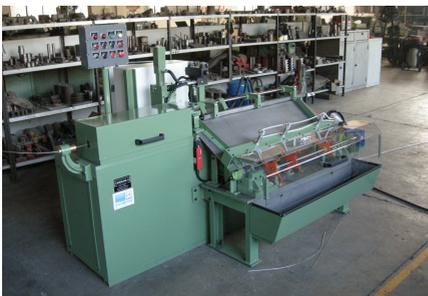
In abbinamento ad un'unità di pressatura, si possono produrre anche elettrodi per la saldatura TIG in vari diametri (da  $\varnothing 1$  a  $\varnothing 4$  mm), lunghezze (da 500 mm fino a 1000 mm) e materiali (acciaio inox, leghe di alluminio, ferro ramato CO2, leghe di rame, et cetera...).
