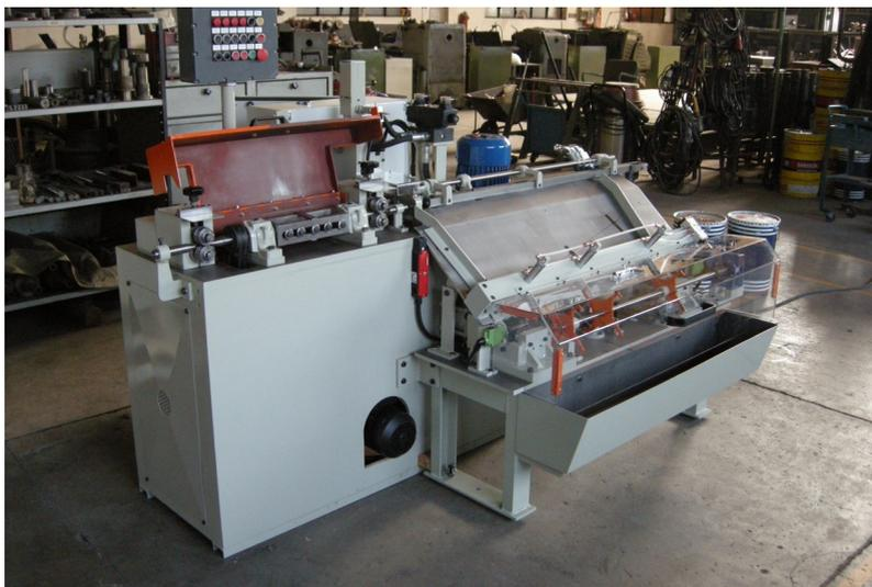
**Macchina raddrizzatrice e troncatrice per la elevata produzione di barrette per la saldatura TIG a bussole di raddrizzatura**
