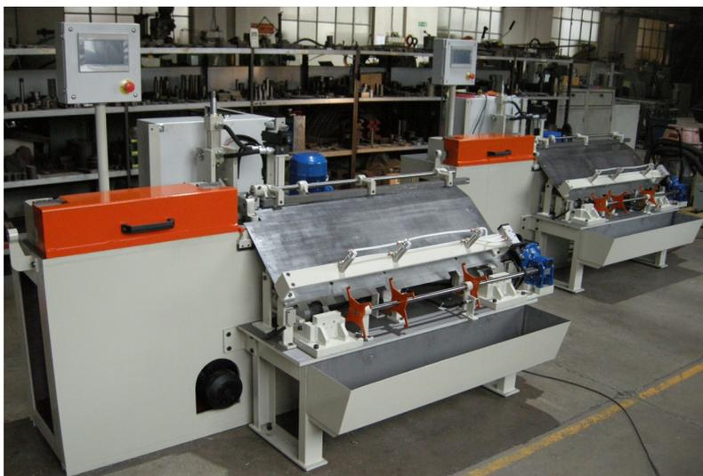
**Macchina raddrizzatrice e troncatrice per la produzione di barrette per la saldatura TIG a bussole di raddrizzatura**
