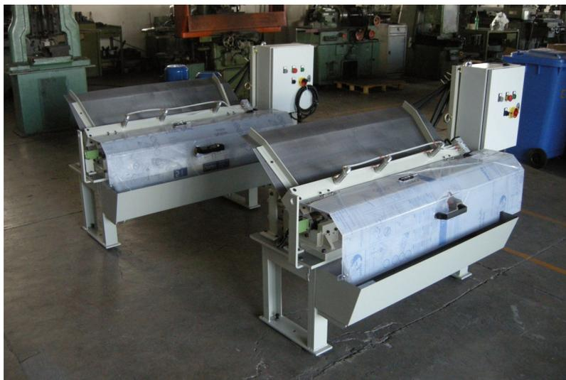
**Unità di pressatura per la stampa delle barrette, da applicare a macchine raddrizzatrici già esistenti**
