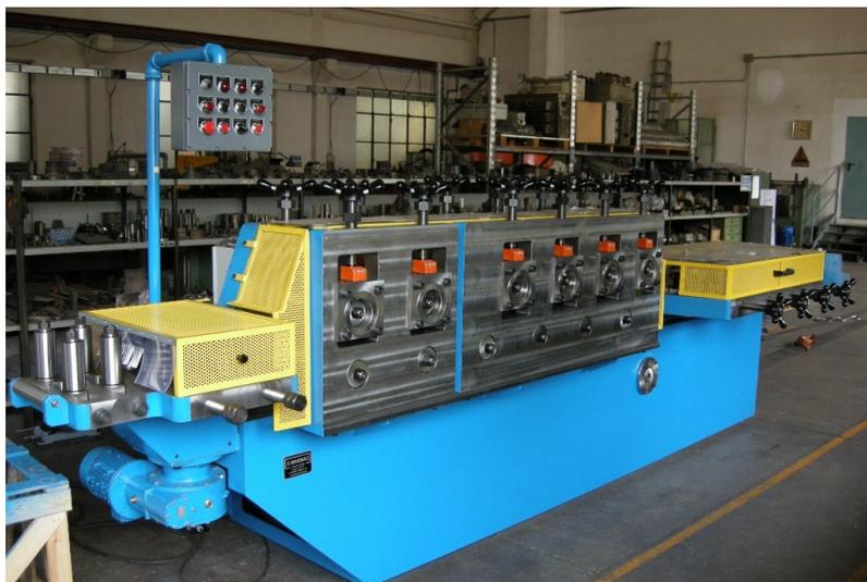
**Macchina raddrizzatrice per la produzione di barre di varia sezione (quadro, rettangolo, esagono, ecc...)**
