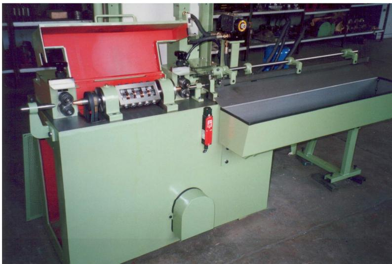
**Macchina raddrizzatrice e troncatrice a bussole di raddrizzatura**
