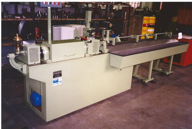
**Macchina raddrizzatrice e troncatrice a bussole di raddrizzatura 1 o 2 Inverter per controllare le velocità del raddrizzatore e dell'avanzamento a seconda delle esigenze del cliente**
