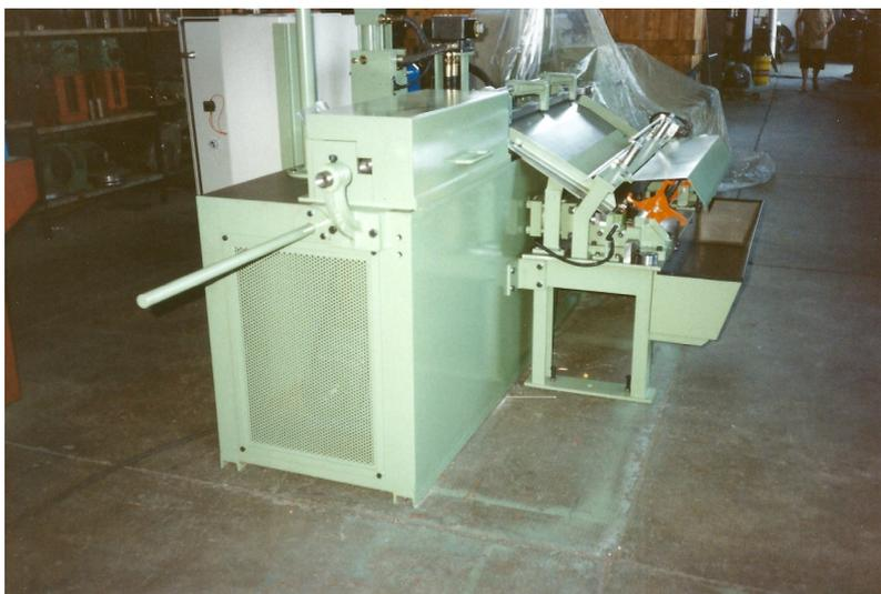
**Macchina raddrizzatrice e troncatrice per la produzione di barrette per la saldatura TIG a rulli iperbolici**
