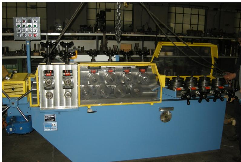
**Macchina raddrizzatrice e troncatrice per la produzione di barrette di varia sezione (quadro, rettangolo, esagono, ecc...)**
